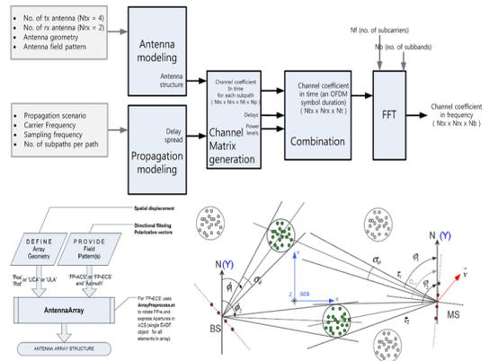
그림 3. CoMP 시스템 채널 계수 모델링
